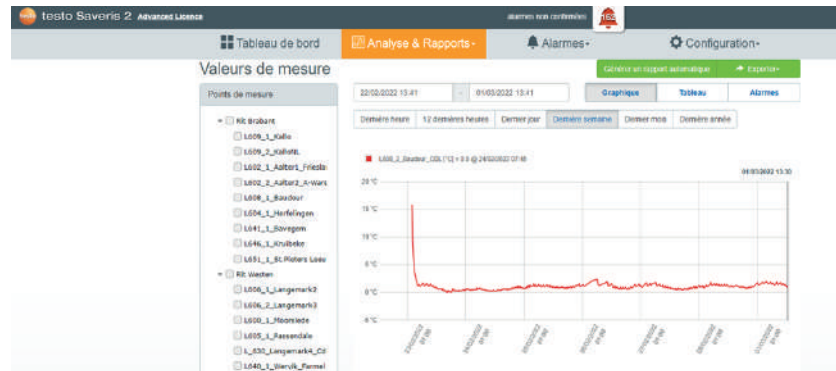
Plateforme pour monitoring de la température
