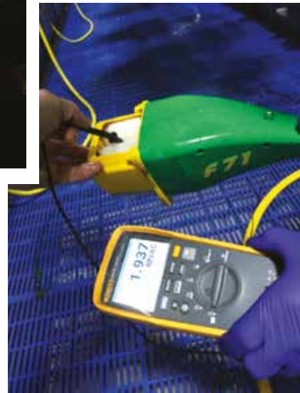
Mise à la terre de la brosse de préparation des pis
