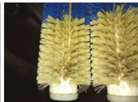
Brosses de préparation d'un robot pas propres
